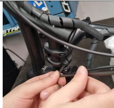
Etapa 17: Retirar os parafusos da mesa de direção. Utilizar chave Allen 4mm
