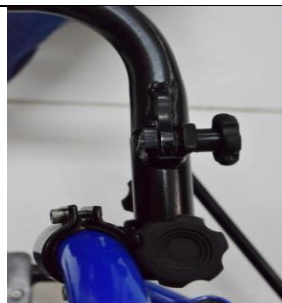
Passo 11: Conferir o alinhamento do suporte junto aos acoplamentos laterais (17,18).
