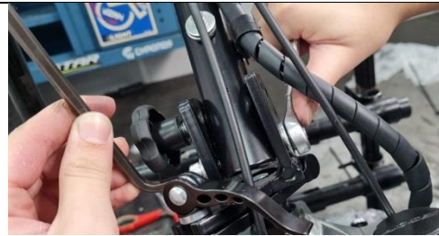
Etapa 11: Afrouxar parafuso da coluna de direção. (Não é necessário remover). Utilizar as chaves Allen 6mm e Combinada 13mm.
