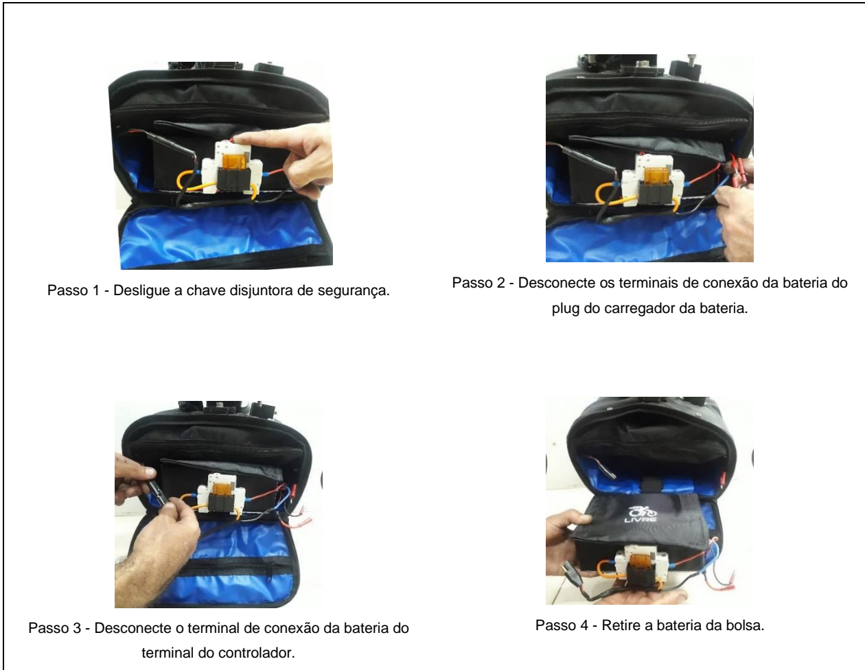
Figura 8 - Sequência para desacoplamento da bateria
