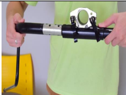
Passo 5: Inserir a curva lado direito (3) no centro do suporte (8).
