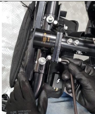
Etapa 4: Destruar o pino de blocagem. Utilizar Chave Allen 5mm.
