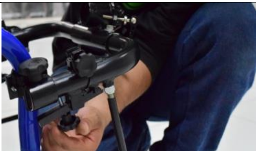
Passo 10: Apertar os manipuladores de segurança (1) na parte inferior dos acoplamentos laterais (17,18).
