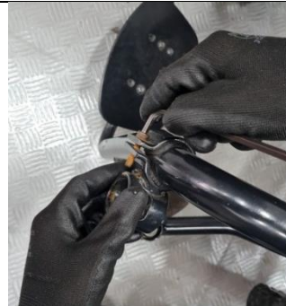
Etapa 2: Remover mancal da cadeira. Utilizar Chave Allen 5mm.
