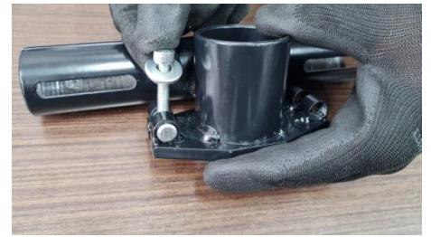
Passo 3: Instalar os pinos de bloqueio (5,6,7) no centro do suporte (8).
