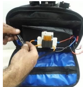
Passo 4 - Conecte o terminal da bateria no terminal do controlador.
