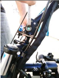
Passo 10: Apertar o parafuso M8 da coluna de direção do KIT LIVRE®. Utilizar as chave Allen 6 mm (11) e combinada 13 mm (16) .
