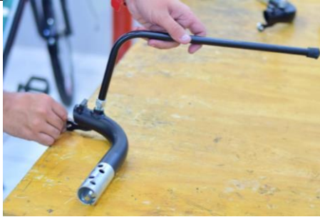
Passo 2: Instalar o cavalete (4) na curva lado direito (3).
