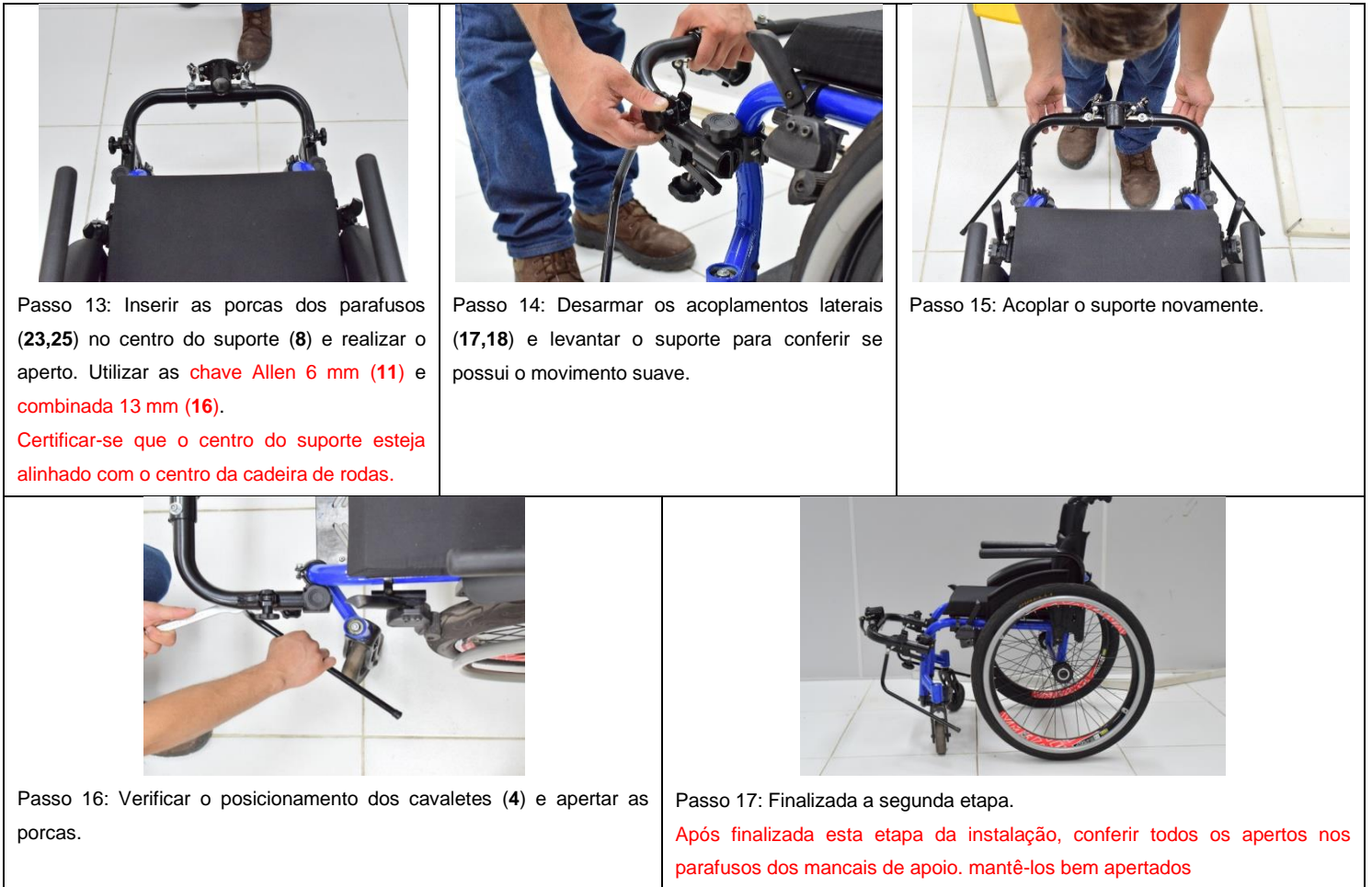
Figura 18 - Processo de instalação do KIT LIVRE® em cadeira de rodas monobloco: Etapa 2.
