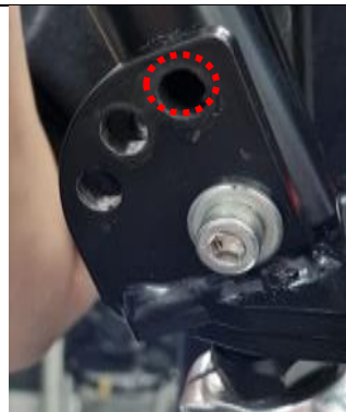
Etapa 13: Utilizar a furação que deixe a coluna de direção reta.
