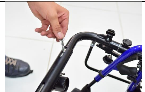
Passo 9: Inserir os parafusos (24,25) sobre o centro do suporte. Recomendável: Utilizar inicialmente o segundo conjunto de furação.
