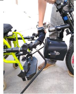
Passo 3: Instalar o KIT LIVRE® no centro do suporte (8).
