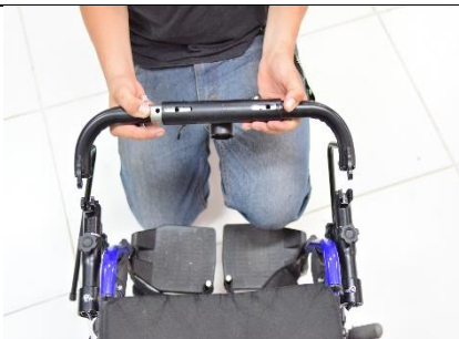
Passo 7: Posicionar o suporte (3,8,26) sobre os acoplamentos laterais (17,18).
