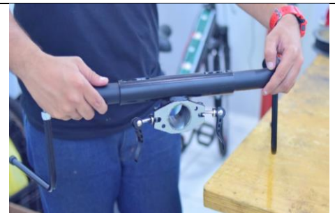
Passo 6: Posicionar o centro do suporte (8) com o acoplamento central voltado para baixo.
