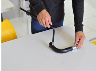
Passo 2: Instalar o cavalete (4) na curva lado direito (3).
